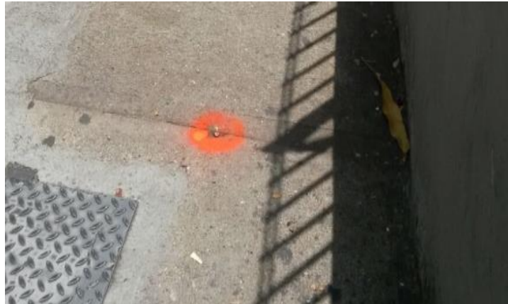
Fig. 23. Señal de los puntos de cambio que integran las poligonales envolventes para el levantamiento con Estación Total. Fuente: Elaboración propia.
